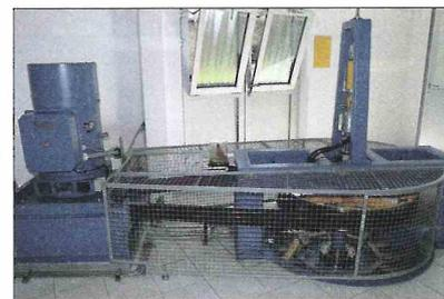
Vor der Modernisierung 2010 war eine Francis-Zwillings-Turbine eingebaut, der Generator hierzu wurde mit Hilfe eines Kamelhaarriemens angetrieben. Diese Turbine hat 106 Betriebsjahre hinter sich und steht nun zur Ausstellung im Garten.
